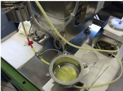
Fig. 2 : Lyse de bactéries *E.coli* en mode recirculation
